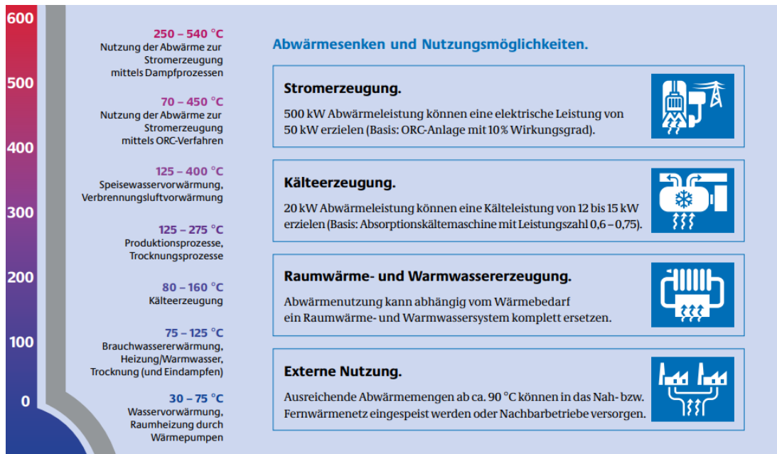
Abbildung 4-8: Nutzung von industrieller und gewerblicher Abwärme in Abhängigkeit vom Temperaturniveau (Erfolgreiche Abwärmennutzung im Unternehmen. - Energieeffizientpotenziale erkennen und erschließen, 2015, S. 4)
